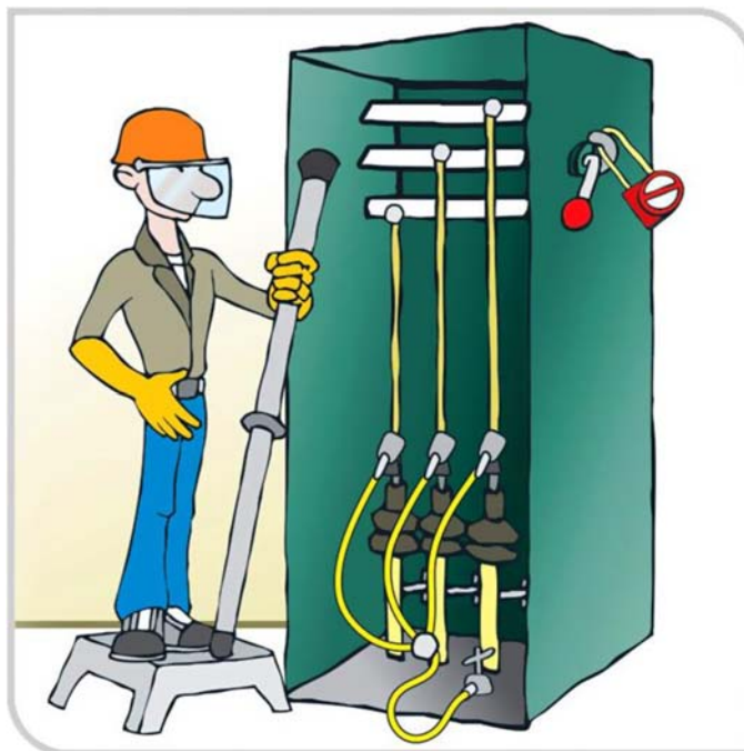
FIGURA 99- PUESTA A TIERRA TEMPORAL EN BARRAJES
